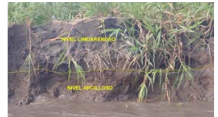
Figura 256. Talud del río en la zona del dique aluvial mostrando un nivel arcilloso bajo una capa o nivel limo-arenoso de cauce aluvial reciente.
